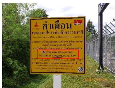
รูปที่ 2-6 สัญลักษณ์แสดงตำแหน่งแนวท่อ โดยมีข้อความและหมายเลขโทรศัพท์แจ้งเหตุอย่างชัดเจน
